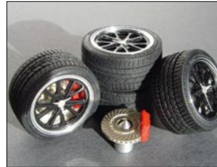
Alugedrehte Felgen mit Kunststoffeinsätzen und dreiteiligen Bremsscheiben.
